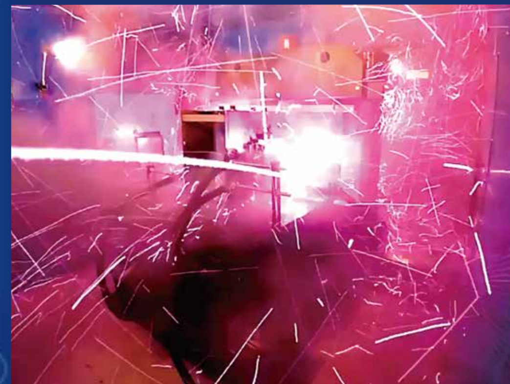
電磁濃縮法による超強磁場発生に伴うコイルの爆発の様子
